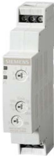
ZEITRELAIS, ELEKTRONISCH MULTIFUNKTION 1 WECHSLER, 7 FUNKTIONEN, 7 ZEITBEREICHE 0,05S...100H AC/DC 12...240V, MIT LED, SCHRAUBANSCHLUSS
