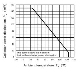
Fig. 11.2 P<sub>C</sub> - T<sub>a</sub>
