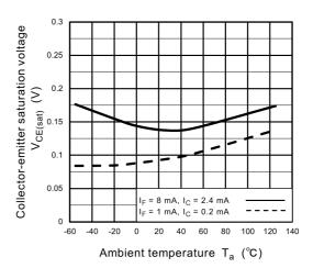
Fig. 11.10 V<sub>CE(sat)</sub> - T<sub>a</sub>
