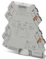
1-kanaliger eingangsschleifengespeister 2-Wege-Trenner mit steckbarer Anschluss technik zur galvanischen Trennung von Analogsignalen. Eingangssignal = Ausgangssignal: 0(4) mA ... 20 mA. Schraubanschlusstechnik.
