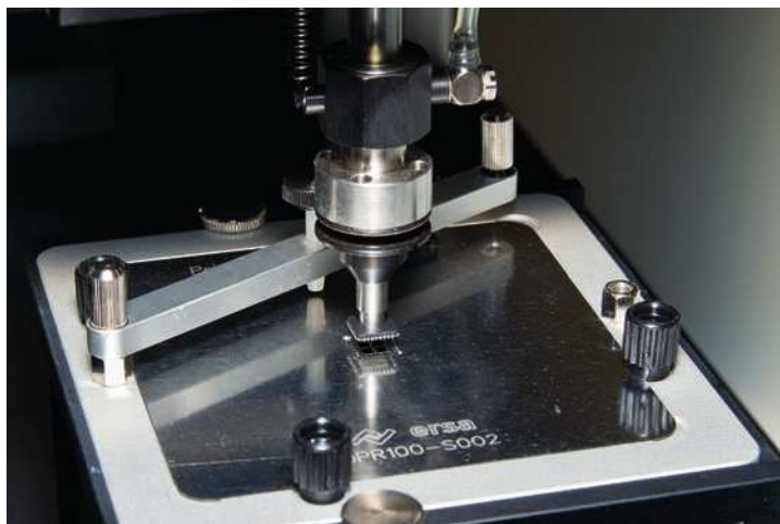
Bauteil ausheben aus Print-Schablone
