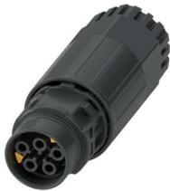
Kupplungssteckverbinder, Artikelfamilie: PRC 20, Farbe: schwarz, Polzahl: 5, Aderquerschnitt min.: 0,5 mm<sup>2</sup>, Aderquerschnitt max.: 2,5 mm<sup>2</sup>, Bemessungsspannung: 400 V, Bemessungsstrom: 20 A, Anschlussart: Schraubanschluss, Kontaktart: Buchse, Einstellmöglichkeit für die Entriegelung: 1. mit einem Werkzeug oder 2. von Hand, Anwendungsbereich: DC
