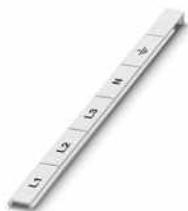
Marker für Klemmen, Streifen, weiß, beschriftet, längs: L1, L2, L3, N, GND, Montageart: verrasten, für Klemmenbreite: 18 mm, Schriftfeldgröße: 18 x 5 mm, Anzahl der Einzelschilder: 5
