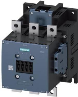
Leistungsschütz, AC-3 265 A, 132 kW / 400 V AC (50-60 Hz) / DC-Betätigung AC/DC 200-277 V Hilfskontakte 2 NO + 2 NC 3-polig, Baugröße S10 Schienenanschlüsse Antrieb: elektronisch mit SPS-Schnittstelle DC 24 V Schraubanschluss
