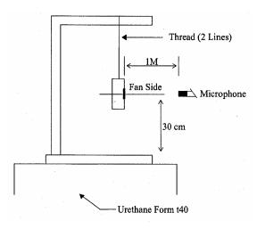
1 METER FROM MICROPHONE TO FAN INTAKE
