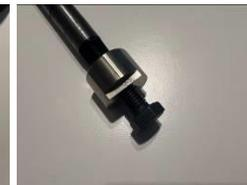
Bild 8: Achsadapter abziehen
