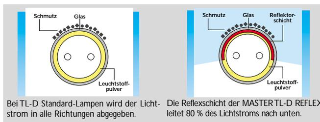
Bei TL-D Standard-Lampen wird der Lichtstrom in alle Richtungen abgegeben.
