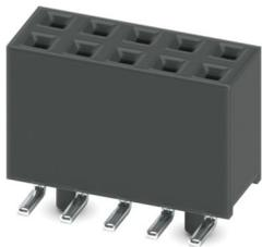
SMD-Sockelleiste, Nennstrom: 3 A, Prüfspannung: 500 V AC, Polzahl: 10, Rastermaß: 2,54 mm, Farbe: schwarz, Kontaktoberfläche: Gold, Kontaktart: Buchse, Montage: SMD-Löten
