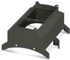
Tragschienengehäuse für den Einsatz in Installationsverteilern nach DIN 43880, Gehäuseoberteil (U11) mit Lüftungsschlitzen, Einbautiefe Anschluss technik: 11,1 mm, Breite: 107,6 mm, Höhe: 89,7 mm, Tiefe: 54,85 mm, Farbe: schwarz (9005)
