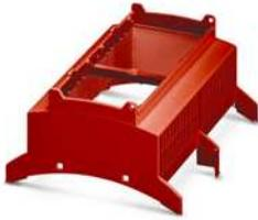
Tragschienengehäuse für den Einsatz in Installationsverteilern nach DIN 43880, Gehäuseoberteil (U11) mit Lüftungsschlitzen, Einbautiefe Anschluss technik: 11,1 mm, Breite: 107,6 mm, Höhe: 89,7 mm, Tiefe: 54,85 mm, Farbe: rot (3000)
