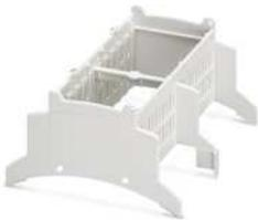
Tragschienengehäuse für den Einsatz in Installationsverteilern nach DIN 43880, Gehäuseoberteil (U22) mit Lüftungsschlitzen, Einbautiefe Anschluss technik: 22,35 mm, Breite: 107,6 mm, Höhe: 89,7 mm, Tiefe: 54,85 mm, Farbe: grau (7045)
