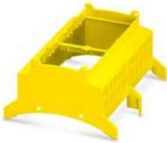
Tragschienengehäuse für den Einsatz in Installationsverteilern nach DIN 43880, Gehäuseoberteil (U11) mit Lüftungsschlitzen, Einbautiefe Anschluss technik: 11,1 mm, Breite: 107,6 mm, Höhe: 89,7 mm, Tiefe: 54,85 mm, Farbe: gelb (1018)
