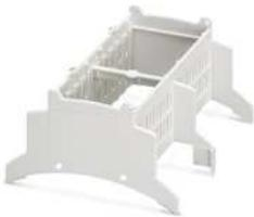
Tragschienengehäuse für den Einsatz in Installationsverteilern nach DIN 43880, Gehäuseoberteil (U22) mit Lüftungsschlitzen, Einbautiefe Anschluss technik: 22,35 mm, Breite: 107,6 mm, Höhe: 89,7 mm, Tiefe: 54,85 mm, Farbe: lichtgrau (7035)
