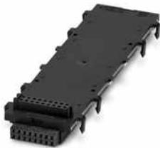
Tragschienen-Busverbinder, Farbe: schwarz, Nennstrom: 3 A (Summenstrom max. 25 A), Bemessungsspannung (III/2): 30 V, Polzahl: 16, Rastermaß: 2,54 mm, Montage: Tragschienenmontage, Verriegelung: ohne
