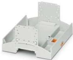
Tragschienengehäuse für den Einsatz in Installationsverteilern nach DIN 43880, Gehäuseunterteil mit Fußriegel, Breite: 107,6 mm, Höhe: 89,7 mm, Tiefe: 48,9 mm, Farbe: lichtgrau (7035), Querverbindung: Tragschienen-Busverbinder (optional), Polzahl Querverbinder: 16
