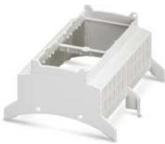
Tragschienengehäuse für den Einsatz in Installationsverteilern nach DIN 43880, Gehäuseoberteil (U11) mit Lüftungsschlitzen, Einbautiefe Anschluss technik: 11,1 mm, Breite: 107,6 mm, Höhe: 89,7 mm, Tiefe: 54,85 mm, Farbe: lichtgrau (7035)
