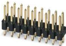
Stiftleiste, Farbe: schwarz, Kontaktart: Stift (male), Anzahl der Potenziale: 18, Anzahl der Reihen: 2, Polzahl: 18, Anzahl der Anschlüsse: 18, Artikelfamilie: PSTD 0,65X0,65/..-V, Rastermaß: 2,54 mm, Montage: THR-Löten, Pin-Layout: Lineares Pinning, Pinlänge [P]: 2,5 mm, Verriegelung: ohne, Verpackungsart: verpackt im Karton
