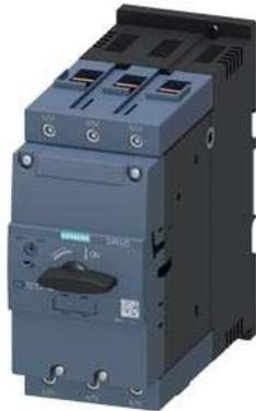
Leistungsschalter Baugröße S3 für den Motorschutz, CLASS 10 A-Auslöser 75...93 A N-Auslöser 1300 A Schraubanschluss Standardschaltvermögen
