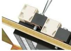
Anrasten eines Zusatzmoduls mit Kontakt zur Befestigungsauflage
