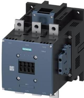
Schütz, AC-1, 690 A/690 V/40 °C, S12, 3-polig, AC/DC 220-240V, mit Varistor, 2S+2Ö, Anschlussschiene/ Schraubanschluss
