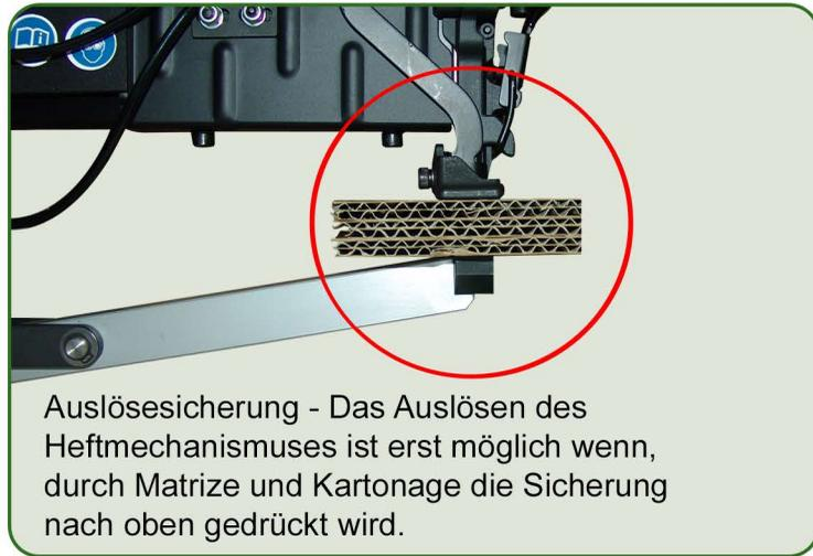
Auslösesicherung - Das Auslösen des Heftmechanismus ist erst möglich wenn, durch Matrice und Kartontage die Sicherung nach oben gedrückt wird.
