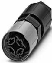
Steckverbinder, QUICKON-Anschluss, Polzahl: 2+PE, 0,5 mm<sup>2</sup> ... 1,5 mm<sup>2</sup>, 690 V, 17,5 A, schwarz, mit QUICKON-Mutter, Leitungsaußendurchmesser: 5 mm ... 9,5 mm
