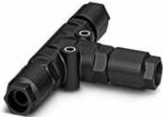
T-Verteiler, QUICKON-Anschluss, Polzahl: 2+PE, 0,5 mm<sup>2</sup> ... 1,5 mm<sup>2</sup>, 690 V, 17,5 A, schwarz, mit drei QUICKON-Muttern, Leitungsaußendurchmesser: 5 mm ... 9,5 mm
