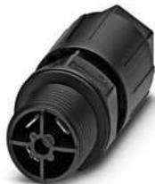
Wanddurchführung, QUICKON-Anschluss, Polzahl: 2+PE, 0,5 mm<sup>2</sup> ... 1,5 mm<sup>2</sup>, 690 V, 15 A, schwarz, mit QUICKON-Mutter, Leitungsaußendurchmesser: 5 mm ... 9,5 mm, Montagegewinde: M20, Flachsteckanschluss (für Flachsteckhülsen nach DIN 46247-2), 1,5 mm<sup>2</sup>
