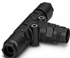
T-Verteiler, QUICKON-Anschluss, Polzahl: 2+PE, 0,5 mm<sup>2</sup> ... 1,5 mm<sup>2</sup>, 690 V, 17,5 A, schwarz, mit zwei QUICKON-Muttern, Leitungsaußendurchmesser: 5 mm ... 9,5 mm
