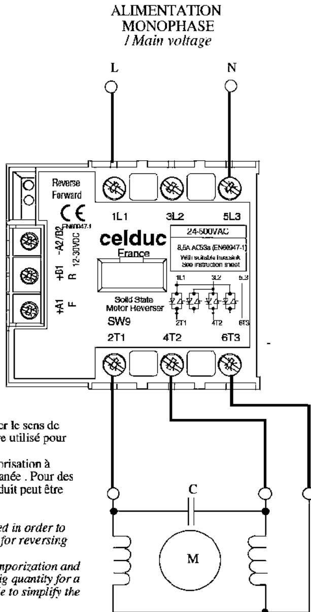
Note : Le relais SW9 développé initialement pour inverser le sens de rotation des moteurs asynchrones triphasés peut aussi être utilisé pour l'inversion de moteurs monophasés .
