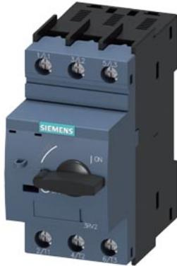
Leistungsschalter Baugröße S0 für Starterkombination Bemessungsstrom 40 A N-Auslöser 480 A Schraubanschluss Standardschaltvermögen
