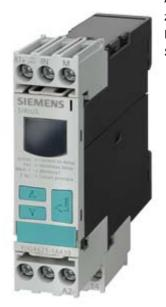
Digitales Überwachungsrelais Stromüberwachung, 22.5 mm von 2-500 mA AC/DC Über- und Unterschreitung Versorgungsspannung: AC/DC 24 V DC und AC 50 bis 60 Hz ohne galvanische Trennung zum Messkreis Anlauf- und Störspitzenverzög. 0,1 bis 20 s Hysterese 0.1 bis 250 mA 1 Wechsler mit oder ohne Fehlerspeicher Schraubanschluss Nachfolgeprodukt für 3UG3521-1AC...
