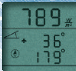
Solare Einstrahlung, Neigungswinkel und Kompasspeilung
