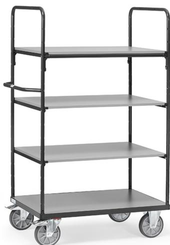
Ensemble mécano-soudé, revêtement époxy gris anthracite RAL 7016. 1 plateau fixe et 3 amovibles en mélaminé surface gris moyen. Plateaux amovibles réglables au pas de 100 mm. Charge maximum par plateau : 90 kg. 2 roues pivotantes et 2 roues fixes à bandage TPE, moyeu à roulement à billes central. Freins sur roues pivotantes conformément à la Norme EN 1757-3 (Sécurité des chariots de manutention).
