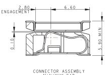
CONNECTOR ASSEMBLY MINIMUM GAP
