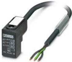
Sensor-/Aktor-Kabel, 3-polig, PVC, schwarz RAL 9005, freies Leitungsende, auf Ventilstecker C (8 mm), mit 1 LED, beschaltet mit Z-Diode, beschaltet mit Z-Diode, Kabellänge: 5 m
