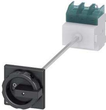
SETRON, Lasttrennschalter 3LD, Hauptschalter, 3-polig, I<sub>n</sub>: 125 A, Betriebsleistung / bei AC-23 A bei 400V: 45 kW, Bodenbefestigung mit Türkupplung, Drehantrieb, schwarz, 4-Loch Befestigung der Handhabe
