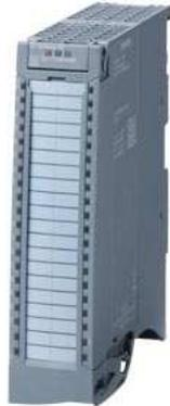
SIMATIC S7-1500, Digitaleingabemodul DI 16xNAMUR HF, 16 Kanäle in Gruppen zu 8; für 8,2V NAMUR-Geber; Sensorversorgung 8,2V; Eingangsverzögerung; parametrierbar 0,05 ... 20ms; integr. Zählfunktion bis 20kHz Impulsverlängerung; Flatter-überwachung; Signalinvertierung Diagnose; Prozessalarml; alle zur Schirmung notwendigen Komponenten im Lieferumfang enthalten; Frontstecker (Schraubklemmen oder Push-In) bitte separat bestellen
