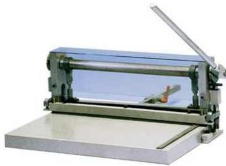
Die Plattenschere Typ Ne-Cut ist speziell für den Zuschnitt von Leiterplatten bis 3.0 mm oder Aluminium bis 1.5 mm Stärke konzipiert worden. Je nach Anforderung können ebenso Stahlbleche (von 0,05 bis 1 mm), Kunststoffe (bis 5 mm), Filmmaterialien sowie Papier auf dem Gerät verwindungsfrei geschnitten werden. Nach Rücksprache auch dickere Aluminiumbleche. Durch die transparente Abdeckhaube lassen sich Einzelstücke auch "auf Sicht" schneiden.
