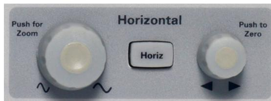
**Abbildung 4** Horizontal-Steuerelemente (X-Achse) des Oszilloskops
