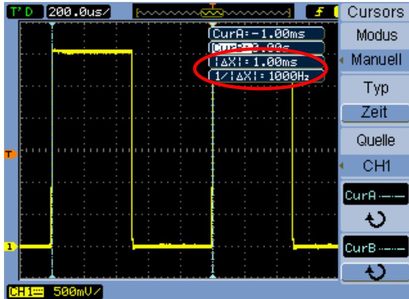
**Abbildung 10** Verwenden der Zeit-Cursor zur Messung von Periode und Frequenz der Rechteckwelle
