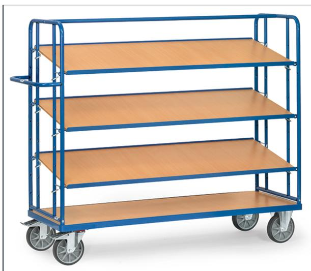
Ensemble mécano-soudé, revêtement époxy bleu RAL 5007. 1 plateau fixe et 3 plateaux amovibles en mélaminé surface effet hêtre avec rebord de 15 mm sur les grands côtés. Plateaux amovibles réglables au pas de 120 mm. Angle d'inclinaison 15° ou 30°. 2 roues pivotantes et 2 roues fixes à bandage TPE, moyeu à roulement à billes central. Freins sur roues pivotantes conformément à la Norme EN 1757-3.
