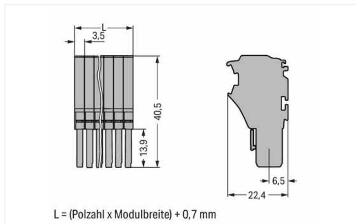
$$L = (\text{Polzahl} \times \text{Modulbreite}) + 0,7 \text{ mm}$$
