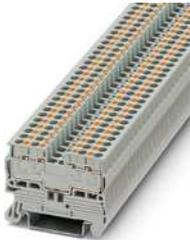
Durchgangsklemme, Nennspannung: 500 V, Nennstrom: 17,5 A, Anschlussart: Push-in-Anschluss, Bemessungsquerschnitt: 2,5 mm<sup>2</sup>, Querschnitt: 0,14 mm<sup>2</sup> - 4 mm<sup>2</sup>, Montageart: NS 35/7,5, NS 35/15, Farbe: grau
