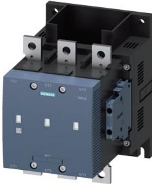
Vakuumschütz AC-3e/AC-3 225 A, 110 kW / 400 V, 3-polig, Antrieb: ohne Hilfskontakte 2 S + 2 Ö Hauptstr.: Schiene Steuer- und Hilfsstromkreis: Schraubanschluss
