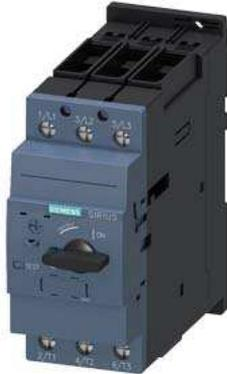
Leistungsschalter Baugröße S2 für den Motorschutz, CLASS 20 A-Auslöser 12...17 A N-Auslöser 260 A Schraubanschluss Standardschaltvermögen
