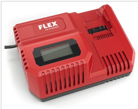
Zum Laden von 10,8 und 18,0 V Akkupacks. Mit großformatigem LCD Display für Batteriediagnostik und Ladezustand. Ladezeit: ca. 40 min für 18,0 V / 2,5 Ah und ca. 50 min für 18,0 V / 5,0 Ah. Durch ein spezielles Ladeverfahren werden 80% der Ladekapazität nach ca. 30 min erreicht. Mit integrierter Akkupackkühlung, Überhitzungs-, Entladungs- und Überlastschutz.
