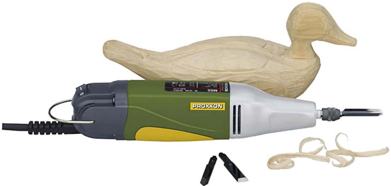
Auch Gips kann bearbeitet werden. Antrieb: Balancierter DC-Spezialmotor, leise und extrem langlebig. Getriebekopf aus Alu-Druckguss. Hauptgehäuse aus glasfaserverstärktem POLYAMID. 3 hochwertige, japanische Messereinsätze aus Bi-Metall (U-Form, V-Form und Flachmesser) gehören zum Lieferumfang.
