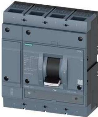
Leistungsschalter 3VA1 IEC Frame 1000 Schaltvermögenklasse H Icu=70kA @ 415V 4-polig, Anlagenschutz TM240, ATAM, In=800A Überlastschutz Ir=560A...800A Kurzschlusschutz Ii=5...10 x In N-Leiter ungeschützt Schraubenflanschanschluss
