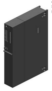
SIPLUS S7-400 CPU 416-3 -25 ... +70°C mit Conformal Coating based on 6ES7416-3XS07-0AB0 . Zentralbaugruppe mit: Arbeitsspeicher 16 MB, (8 MB Code, 8 MB Daten), Schnittstellen 1. Schnittst. MPI/DP 12 MBIT/S, 2. Schnittst. PROFIBUS DP, 3. SS IFM-MODULE steckbar
