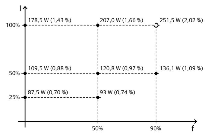
Die Prozentwerte geben die Verluste in Bezug auf die Bemessungsscheinleistung des Umrichters an.
