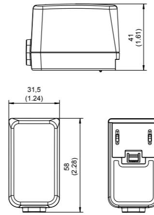
Alle Abmessungen in Millimeter (Inch), Abweichung ± 0,5 (0,02)
