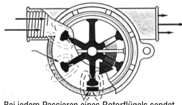
Bei jedem Passieren eines Rotorflügels sendet der Hall-Effekt-Sensor einen Spannungsimpuls
