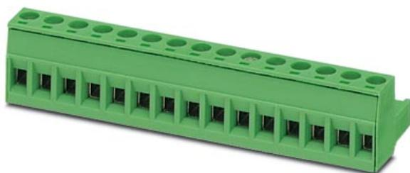
Steckerteil, Nennstrom: 12 A, Bemessungsspannung: 250 V, Raster: 5,08 mm, Polzahl: 16, Anschlussart: Schraubanschluss
