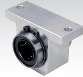
**Werkstoff:** Stranggepresstes Aluminiumgehäuse mit sauber gefräster Auflagefläche. Mit einem geschlossenem Linearkugellager der ISO-Reihe 3 mit Stahlmantel und Kunststoffkäfig. Die Lager sind beidseitig abgedichtet und einbaufertig befettet.
