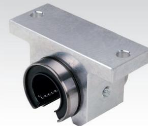
**Werkstoff:** Stranggepresstes Aluminiumgehäuse mit sauber gefräster Auflagefläche. Mit einem offenem Linearkugellager der ISO-Reihe 3 mit Stahlmantel und Kunststoffkäfig. Die Lager sind beidseitig abgedichtet und einbaufertig befettet.
