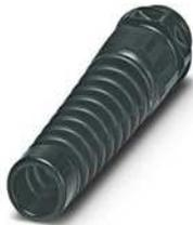
Kabelverschraubung, Material Verschraubung: PA, Kabelaußendurchmesser 3 mm ... 7 mm, Schirmung: nein, Anschlussgewinde: M12 x 1,5, Farbe: tiefschwarz RAL 9005, mit Knickschutz
