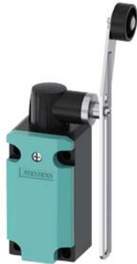
Positionsschalter Metallgehäuse 40 mm nach DIN EN 50041 Geräteanschluss 1x (M20 x 1,5) 1S/2Ö Sprungkontakte Schwenkantrieb rechts/links einstellbar, mit gewinkeltm längenverstellbaren Metallhebel und Kunststoffrolle 22 mm kundenspezifisch Kopf um 270° gedreht
