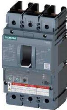
Leistungsschalter 3VA6 UL Frame 150 Schaltvermögenklasse H 65kA @ 480V 3-polig, Anlagenschutz ETU320, LI, In=150A Überlastschutz, 100% rated Ir=60A...150A Kurzschlusschutz Ii=1,5...10 x In ohne Anschluss
