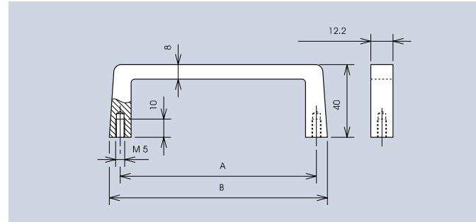
Einschließlich Zylinderschrauben – M5 x 12 und Scheiben
