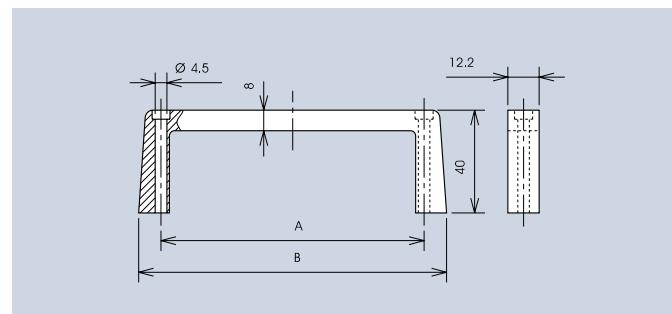
Einschließlich Zylinderschrauben – M4 x 45, Scheiben und Muttern
