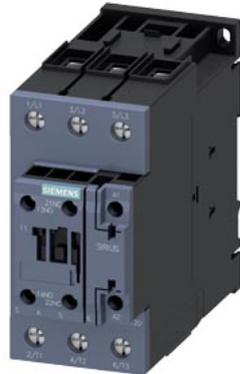
Leistungsschütz, AC-3 65 A, 30 kW / 400 V 1 S + 1 Ö, AC / DC 48-80 V mit Varistor 3-polig, Baugröße S2 Schraubanschluss
