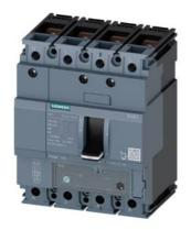
Leistungsschalter 3VA1 IEC Frame 160 Schaltvermögenklasse N Icu=25kA @ 415V 4-polig, Anlagenschutz TM240, ATAM, In=100A Überlastschutz Ir=70A...100A Kurzschlussschutz Ii=5...10 x In N-Leiter ungeschützt Schraubenflachanschluss
