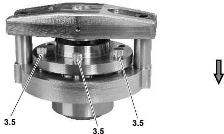
Abb. 25: Haltestifte in Zug-/Druckplatte einstecken.
