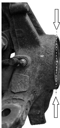
Abb. 46: Sicherungsring vollständig in der Nut eingerastet.
