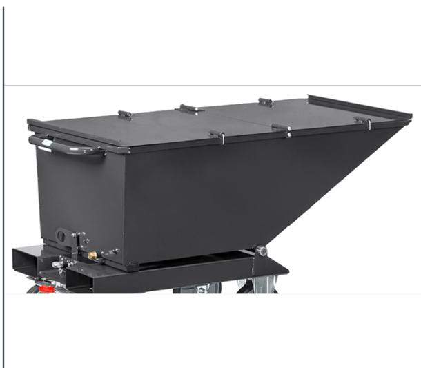
Couvercle rabattable pour benne, ouverture sur 2 parties. Fermeture sécurisée par crochet à ressort. Partie avant peut être verrouillée par crochet à ressort évitant le déversement accidentel. Partie arrière également verrouillable. Goutière pour bonne prise en main sur partie avant et arrière. Tôle d'acier de 1,5 mm, renforcement interne en fer plat de 15 x 3 mm. Pas d'angles saillants externes. Revêtement époxy Gris Anthracite RAL 7016. Livrable à postériori. Supplément par chariot-benne.
